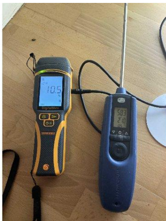
Bild 9: - Invändigt, Källarplan, Fuktkontroll utförd under gränsvärde se bilaga 4
